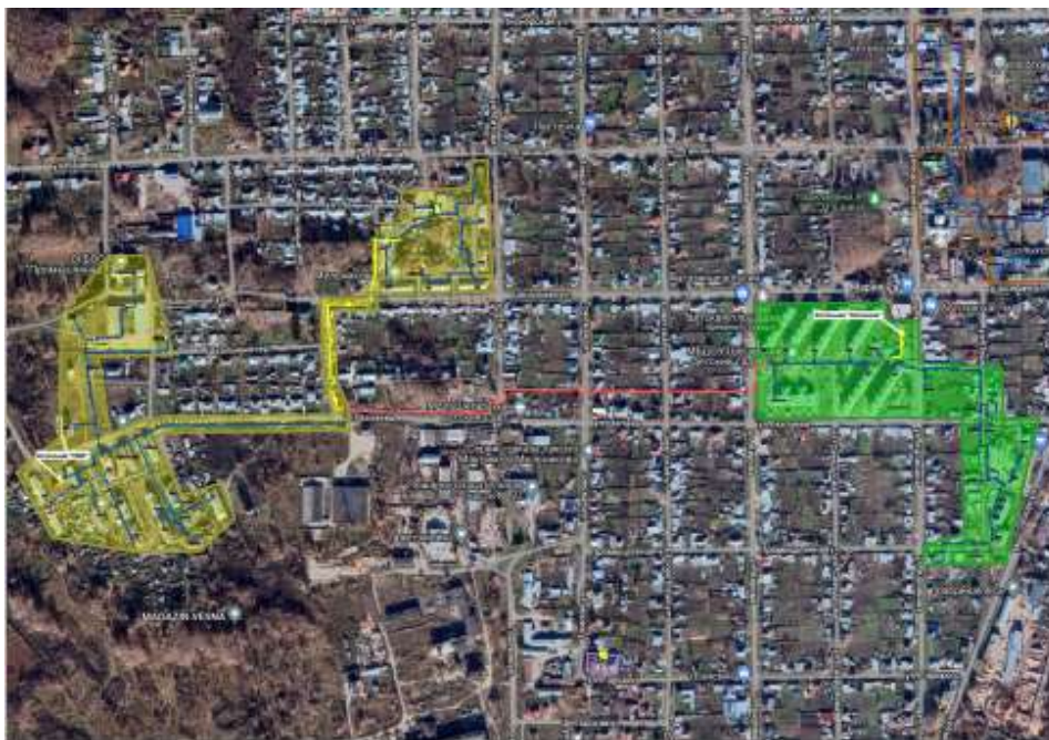
Рисунок 5.1 – Изменение технологических зон котельных (а – технологические зоны существующих газовых котельных «ПМК» и «Титова», б – технологические зоны новой газовой котельной «Калинина» и газовой котельной «ПМК»)
