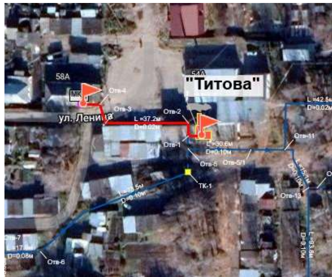
Рисунок 1.41 Путь построения пьезометрического графика котельной «Титова»
