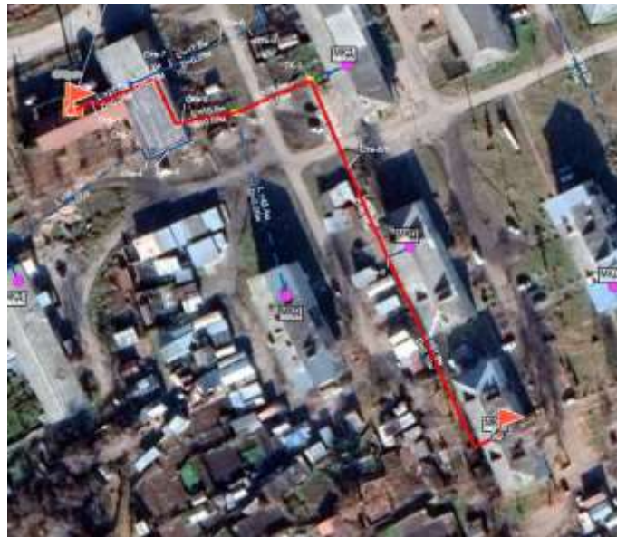
Рисунок 1.1 Путь построения пьезометрического графика котельной «ПМК»
