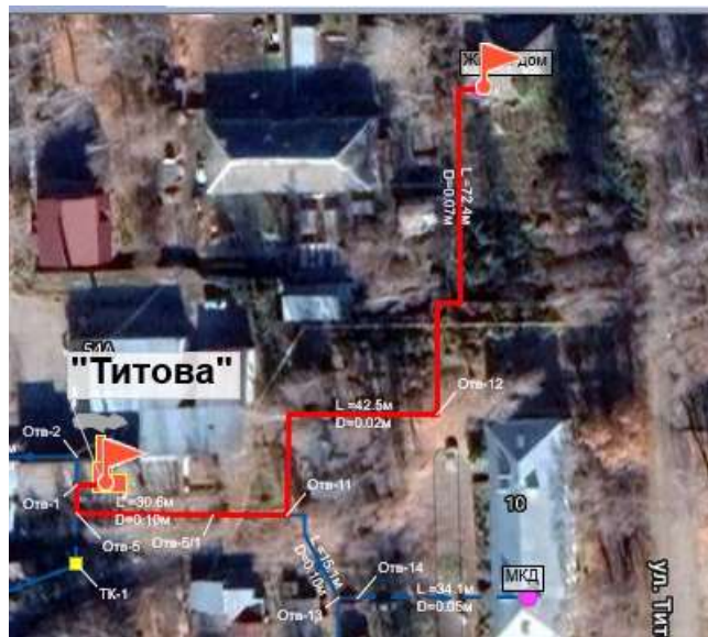
Рисунок 1.43 Путь построения пьезометрического графика котельной «Титова»
