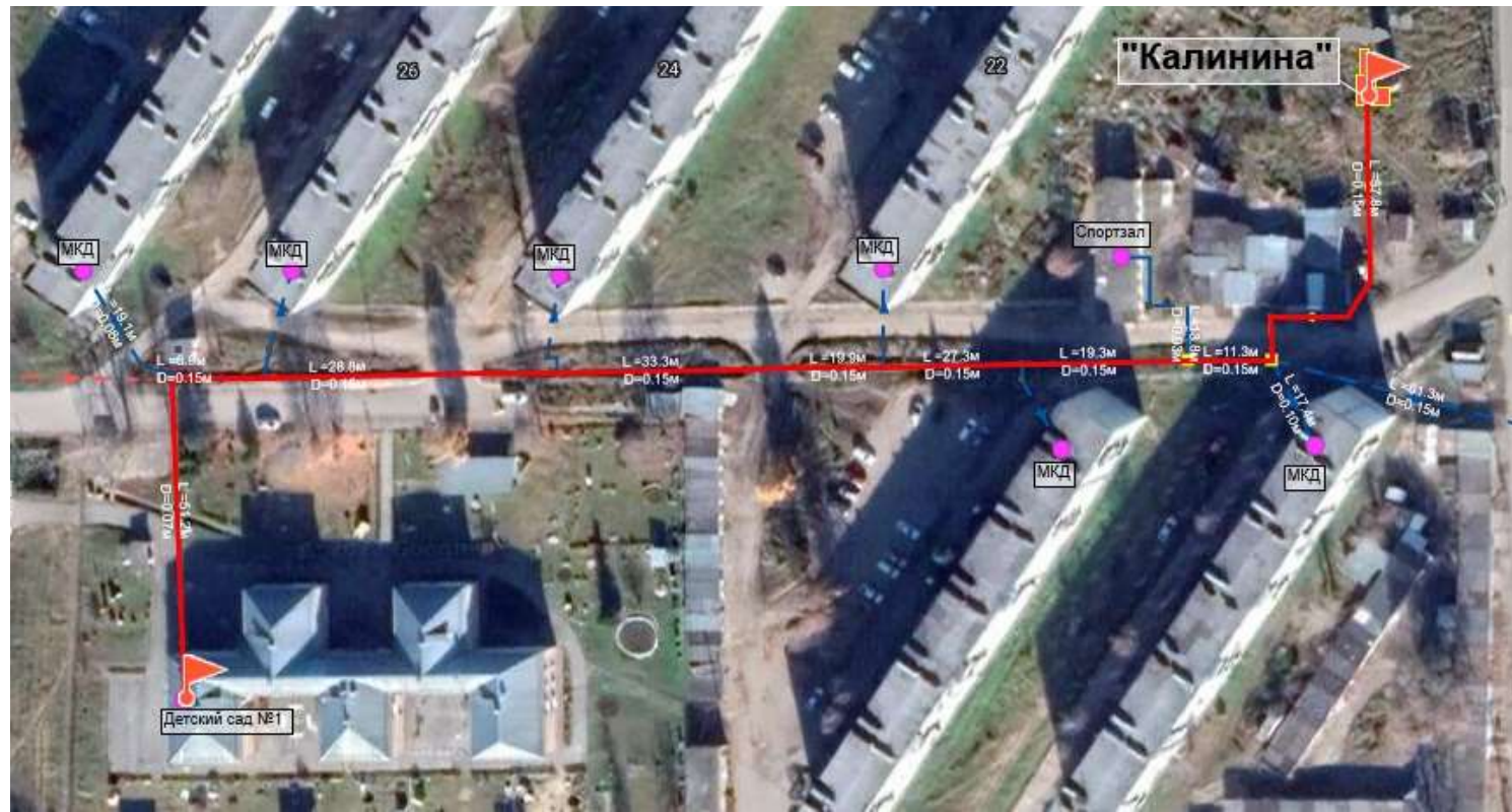
Рисунок 1.19 Путь построения пьезометрического графика котельной «Калинина»
